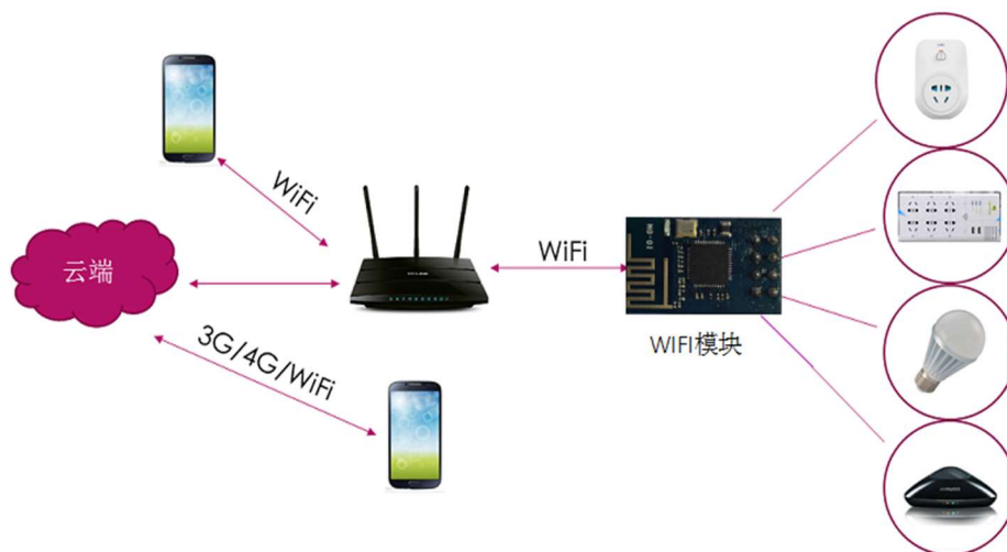
图 3-1: KTM1109 模块应用示意图
